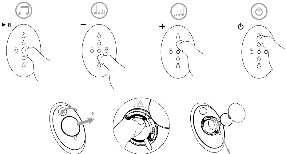
Системой MM-1 можно управлять либо с помощью кнопок, расположенных на сторонах активной колонки либо с пульта (см. рисунок выше). Перед использованием пульта сначала удалите изолирующую прокладку из батарейного отсека. Как это сделать, показано на рисунке выше.
