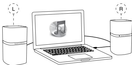
Две колонки MM-1 предназначены для настольного размещения, по обеим сторонам от компьютерного монитора. Активная АС должна быть справа от монитора, а подчиненная – слева. Не устанавливайте колонки слишком широко, если вы сидите близко к монитору. Треугольник, образованный двумя колонками и головой слушателя должен быть приблизительно равносторонним. На рисунке выше проиллюстрировано размещение MM-1.
