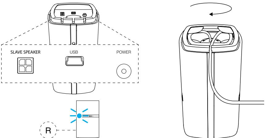
Разъемы для подсоединения к MM-1 расположены на задней панели и на нижней поверхности активной акустической системы. Внизу находятся: разъем питания – **power input**, порт **USB** и разъем для подчиненной АС – **slave speaker**. Сзади расположен линейный вход – **line input** и гнездо для наушников – **headphone**. На рисунке выше показано расположение разъемов для подсоединения.
